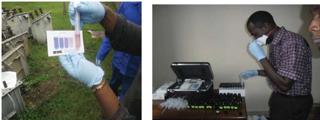
Photo n°8 : Test colorimétrique sur le terrain (a) et préparation des échantillons en vue de l'analyse à la L2000.
